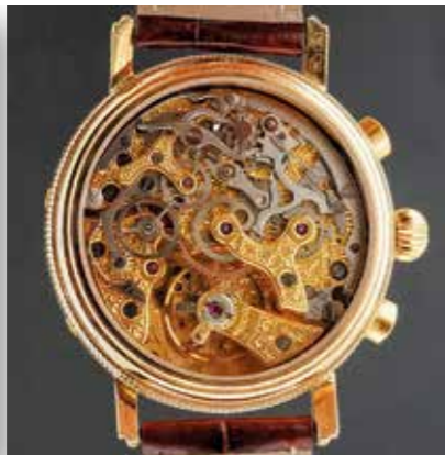
Chronographe Lionel Meylan avec calendrier complet et phases de lune, c. 1990. Calibre Valjoux 88 décoré par Arola aux Bioux.
